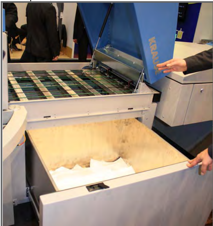
LS Jet Multiformat: Zwischenpapierablage unterhalb des in die Maschine integrierte Conveyors, hier rechtsseitig; normal linksseitig.
