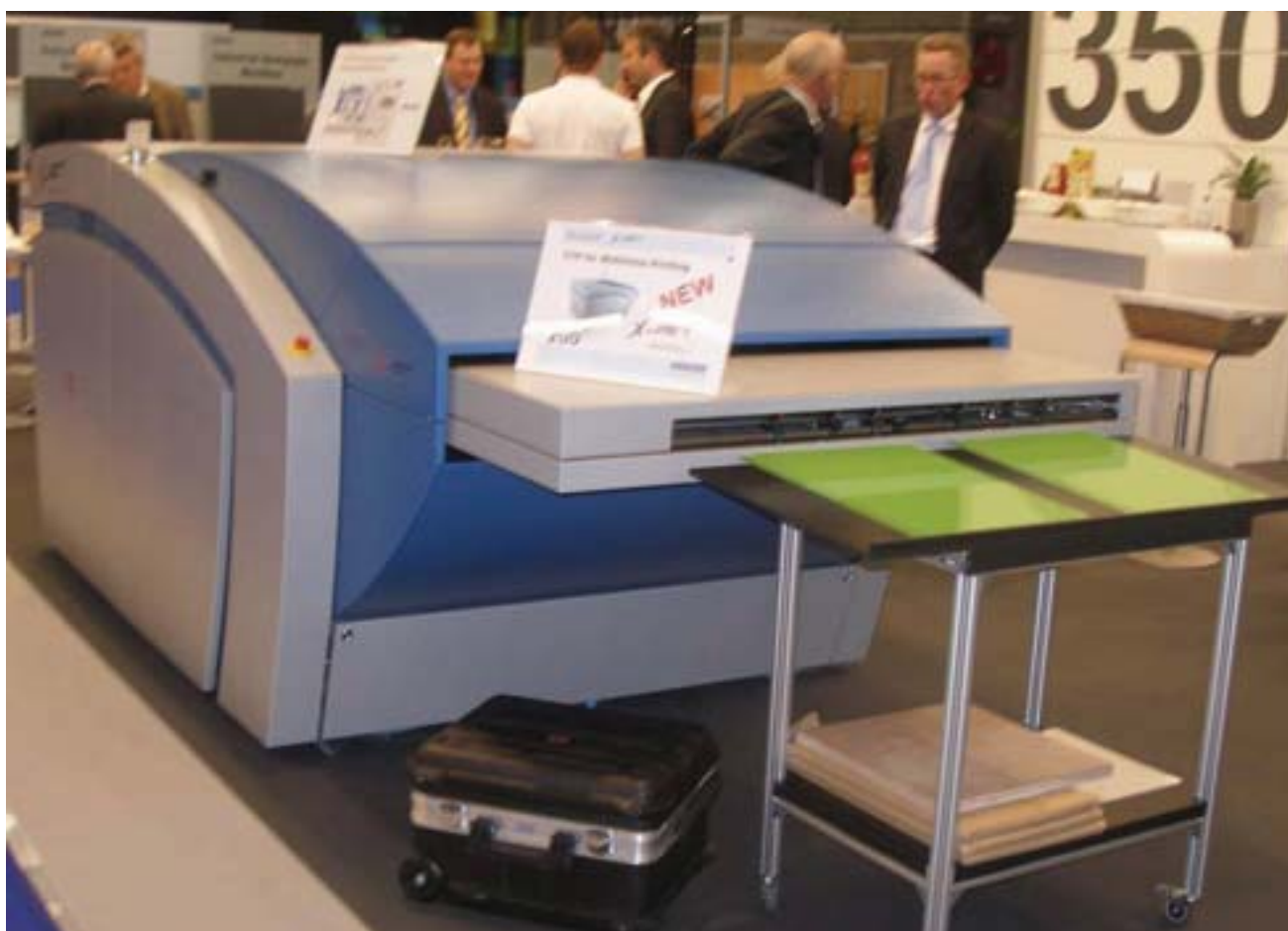
Das Überraschungsmodell, der thermische XJet zur Verarbeitung der Wasserlos-Platten für die KBA Cortina. Wie man unten sieht, werden nach der Bebilderung auch parallel zwei Platten an die Entwicklungsmaschine übergeben. Und ja, der Autofokus der Kamera hat versagt, die ganze Kamera aber erst nach der IFRA, was'n Glück.
