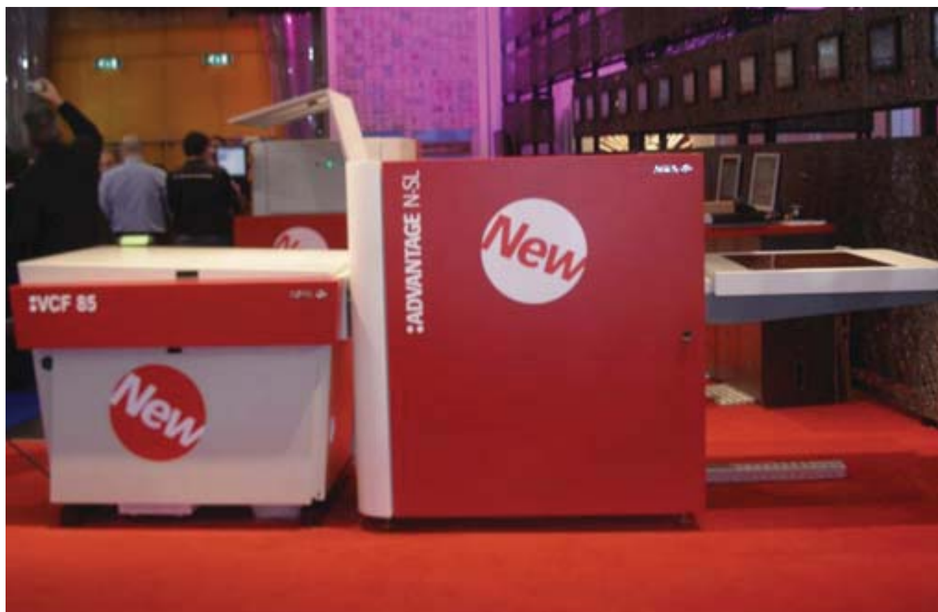
Einer der neuen Advantage Belichter, hier das Modell N-SL, der Automat mit der 100 Platten Kasette, die hier verborgen im Inneren ist. Rechts der Einzig für die manuellen Zufuhr mit dem orangene Lichtschutzdeckel. Links die bereits adaptierte kurze Wasch/Gummierstation für die N-92VCF
