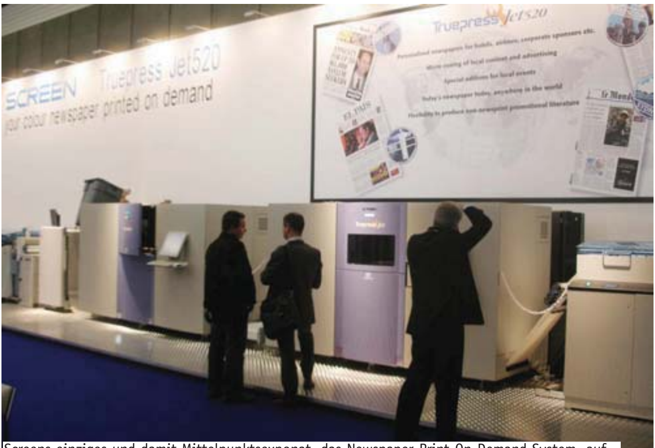
Screens einziges und damit Mittelpunktsexponat, das Newspaper-Print-On-Demand System, aufgebaut auf zwei TruePress Jet 520; rechts im Bild ein Stück vom Rollenfeeder, dann die beiden Druckmaschinen mit einer (hier verdeckten) Wendeeinheit dazwischen; anschließend die Finishing Strecke, die hier nicht mehr aufs Bild paßt.
