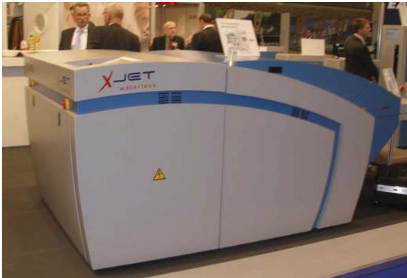
Das Überraschungsmodell, der thermische XJet zur Verarbeitung der Wasserlos-Platten für die KBA Cortina. Wie man unten sieht, werden nach der Bebilderung auch parallel zwei Platten an die Entwicklungsmaschine übergeben. Und ja, der Autofokus der Kamera hat versagt, die ganze Kamera aber erst nach der IFRA, was'n Glück.
