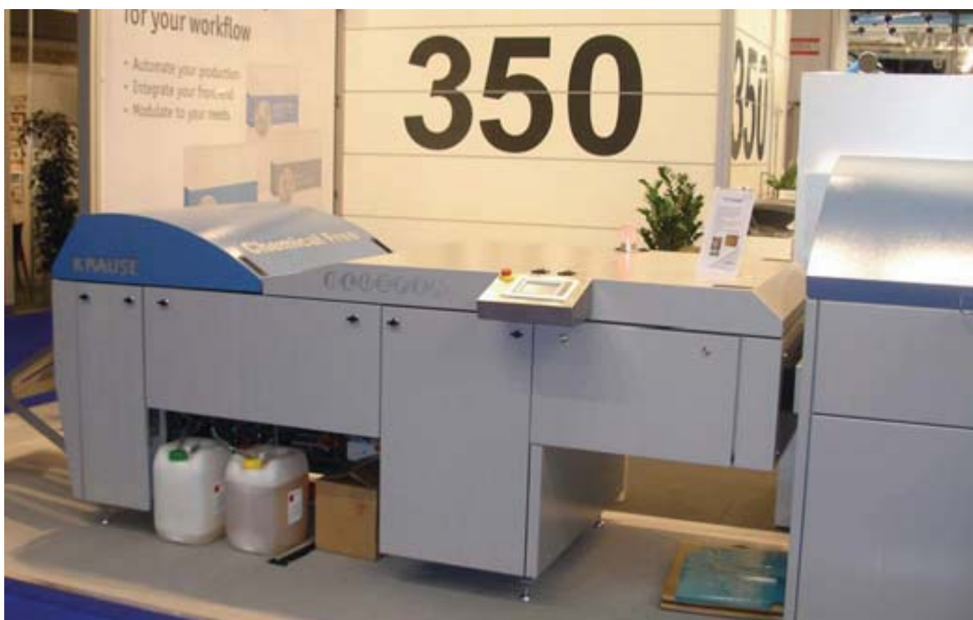
Das Spitzenmodell mit 350 Pl/Std mit der adaptierten Bluefin-Maschine zur Verarbeitung der Fuji Brillia Pro-VN; vom Belichter selbst ist hier (rechts am Rand) nur wenig zu sehen.
