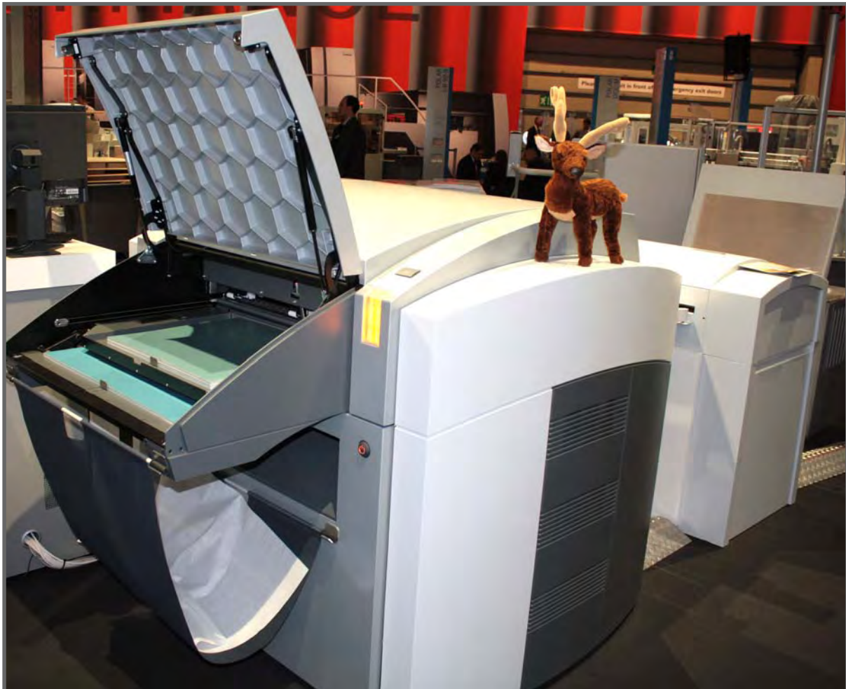
Der Suprasetter A52/A74 mit dem neuen Dualloader, oben die Kassette mit den kleinen Platten
