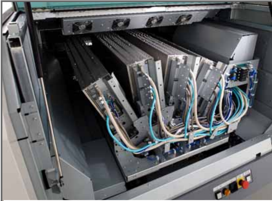
Blick auf die vier Druckköpfe der JetPress 720 von Fuji
